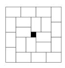
20S320 Cartons per layer6 Layers per pallet120 Cartons per pallet
