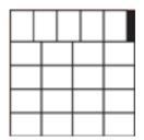
21B221 Cartons per layer10 Layers per pallet210 Cartons per pallet
