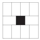
10B110 Cartons per layer4 Layers per pallet40 Cartons per pallet
